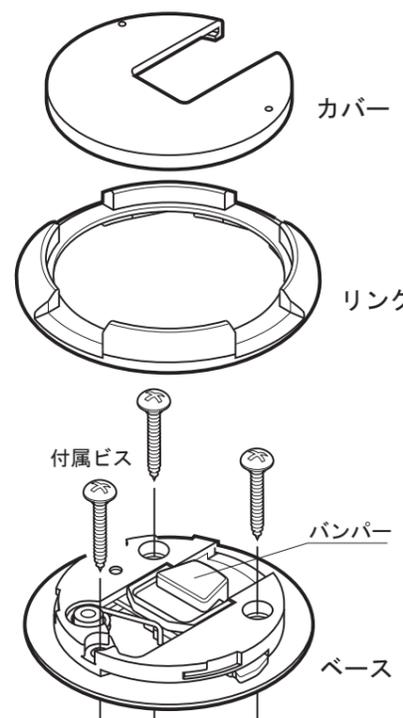
**注意** 電動ドライバーを使用する場合は最後まで締めこまず、手動ドライバーにて軽く締めてください。
