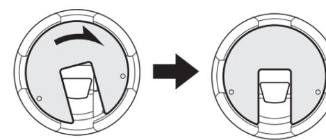
カバーは図の位置に置き、手のひら等で右に回転させ完了します。外す場合はこの逆の操作を行ってください。
